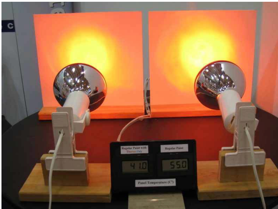
Fig3. Calore trasferito da radiazioni infrarosse e differenza di temperatura dei pannelli.
