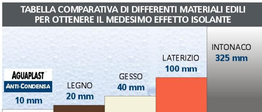
**Esempio di constatata efficacia Anti-Condensa:** Si è provato che su una superficie esposta a 21° C e 40 HR, un'applicazione di Aguaplast Anti-Condensa con spessore minimo di 5 mm aumenta di 8° C il punto di condensazione, rispetto alla stessa superficie non trattata con Aguaplast Anti-Condensa.
